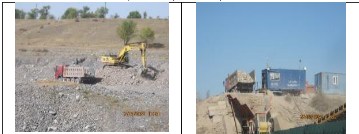
Рисунок 23 Разработка карьера Ак Суу2. Вывоз инертного материала для дробления на КДУ
